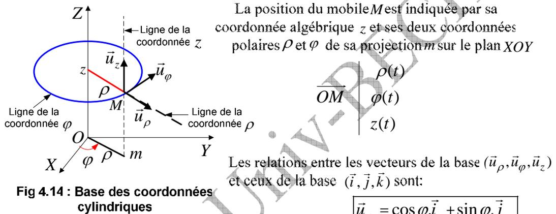
$$\begin{cases} \vec{u}_\rho = \cos \varphi \vec{i} + \sin \varphi \vec{j} \\ \vec{u}_\varphi = -\sin \varphi \vec{i} + \cos \varphi \vec{j} \\ \vec{u}_z = \vec{k} \end{cases} \quad (4.39)$$
