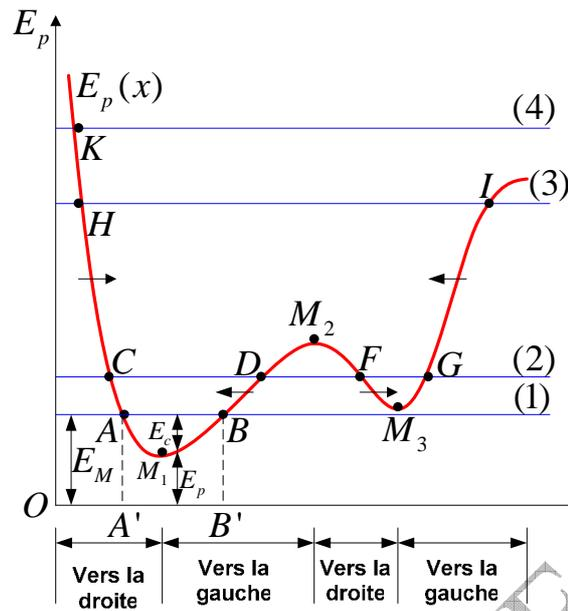
Fig 6.15: Relation entre le mouvement suivant une ligne droite et l'énergie potentielle
