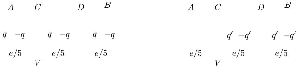
2.b. On a trois condensateurs en série de capacités égales à  $C' = \frac{\epsilon_0 S}{e/5} = 5C$ . Le système est équivalent à un seul condensateur de même charge  $q$ , de potentiel  $V$  et de capacité équivalente  $C_{eq} = \frac{C'}{3} = \frac{5}{3}C$ . La charge est  $q = VC_{eq} = \frac{5}{3}VC = 1.16 \times 10^{-10}$  C. (1)
