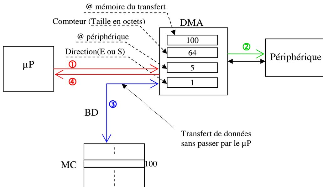
① Le  $\mu P$  positionne les ports (registres) de la DMA en lui indiquant l'@ mémoire dans/ depuis laquelle les données seront sauvegardées/envoyées, la taille des données à transférer, l'@ du périphérique d'E/S et la direction (entrée ou sortie) ;
